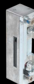
■ PÈNE JOURNALIER Complément indispensable de la barre de tirage, il permet d'ouvrir la porte sans utiliser la clé Disponibles uniquement sur portes d'entrée 1 vantail. Pour des raisons d'accessibilité le pêne journalier en position jour se déclenche avec une poussée inférieure à 50N. Une rafale de vent peut ouvrir la porte, l'installation est donc à réserver aux endroits protégés.
